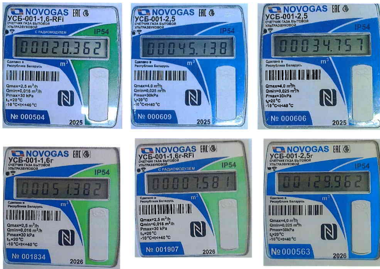
Рисунок 1.2 – Фотография маркировки счетчиков газа бытовых ультразвуковых УСБ-001, на которых проводились испытания
